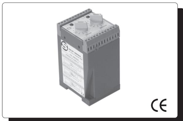
**Alimentatore / interfaccia amplificatrice per sensori tipo Namur (non amplificati) ed amplificati sia con tecnologia NPN che PNP. Con l'ingresso per un sensore e due relè d'uscita, la doppia selezione della temporizzazione di ritardo rende possibile la realizzazione di semplici applicazioni.**
