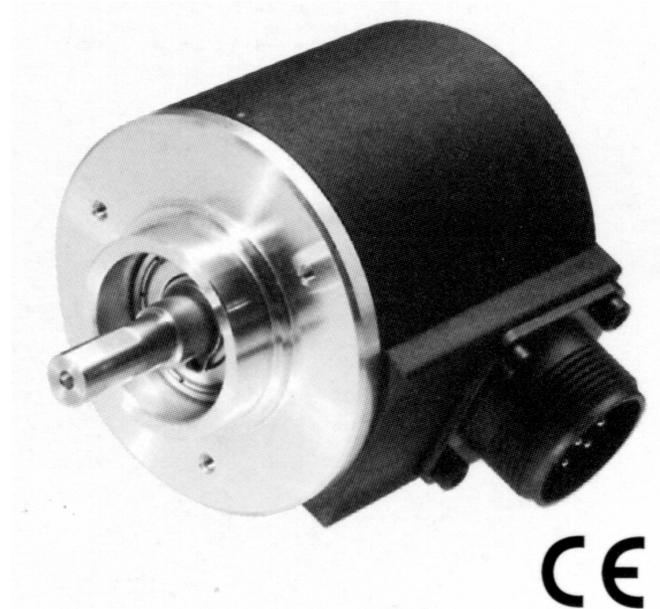
Las salidas de señal son de tipo Push-Pull, por lo que pueden conectarse tanto a entradas tipo NPN como PNP. Los pulsos de salida tienen una amplitud igual a la tensión de alimentación, la corriente máxima de salida es de 100 mA
