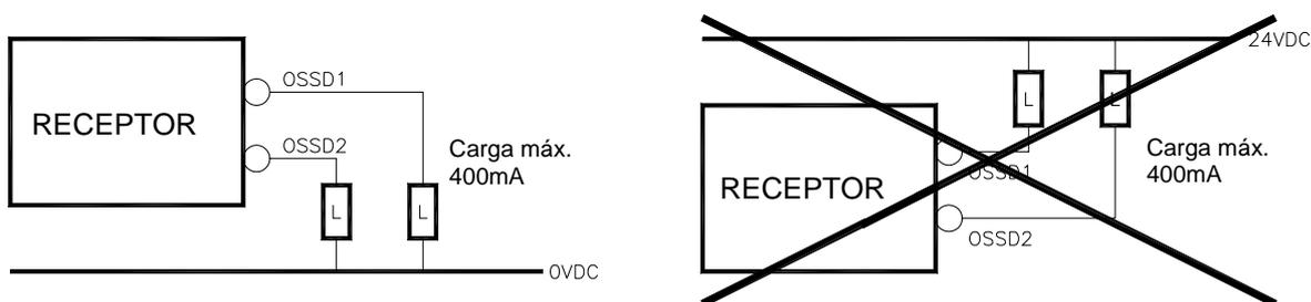
Figura 26 - Correcta conexión de carga en las salidas
