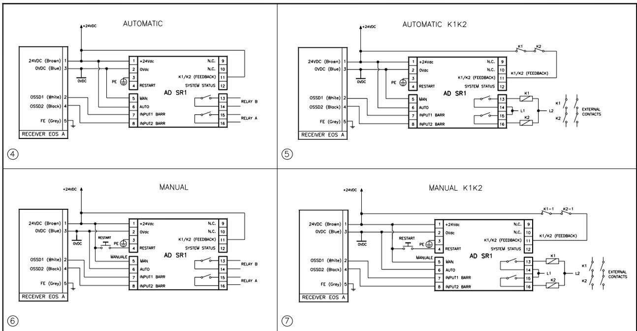
Figura 24 - EOS4 A: Ejemplos de conexión
