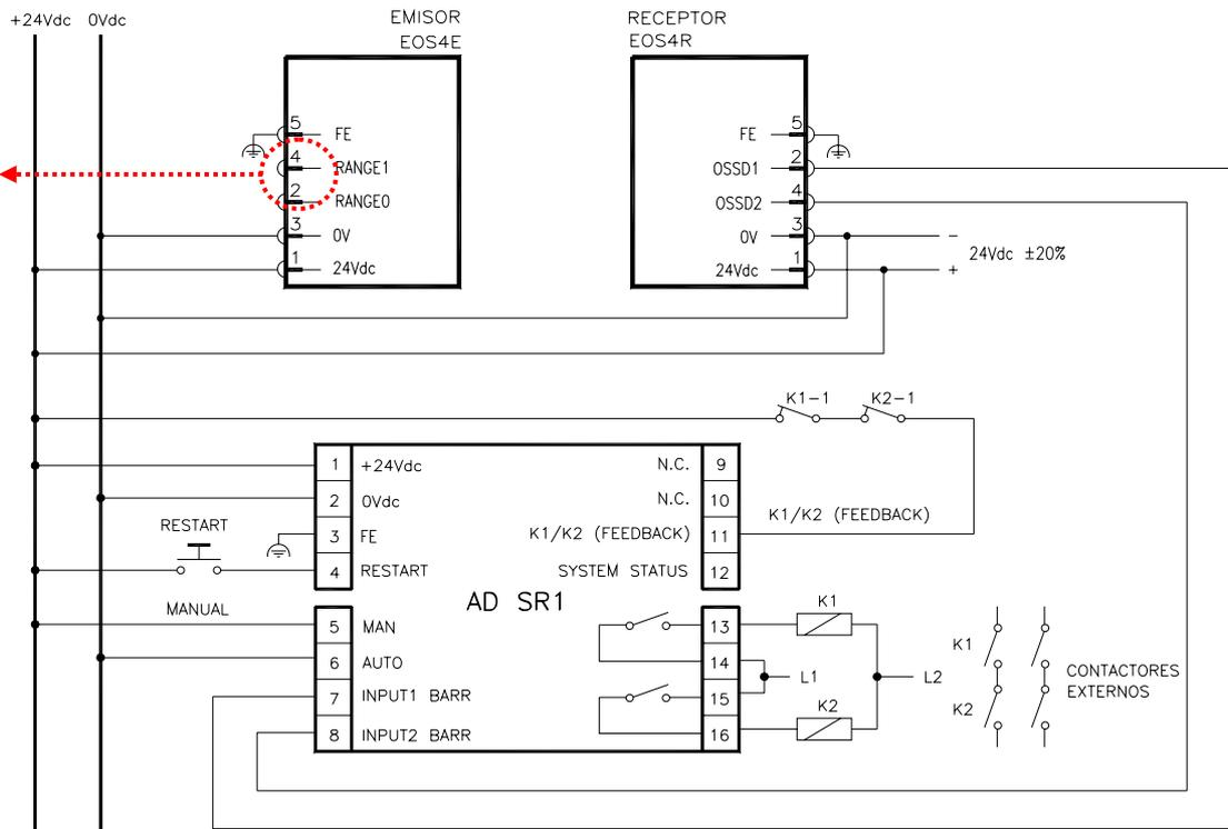
Figura 21 - EOS4 A: Funcionamiento manual con módulo ADSR1
