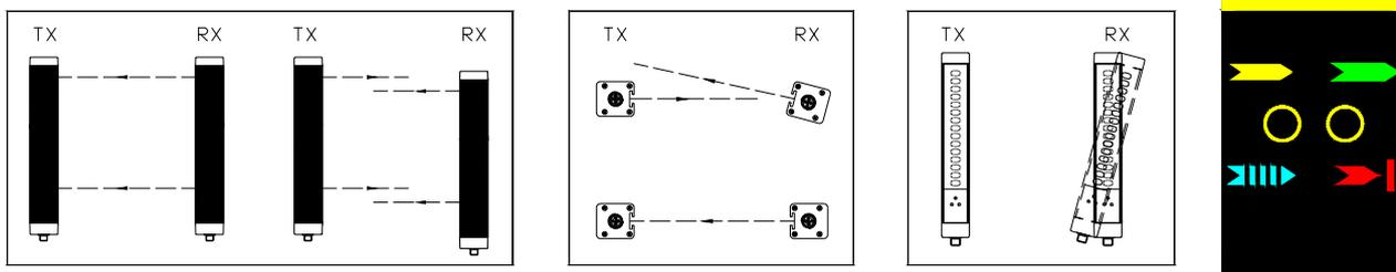
Figura 11 - Alineación óptica
