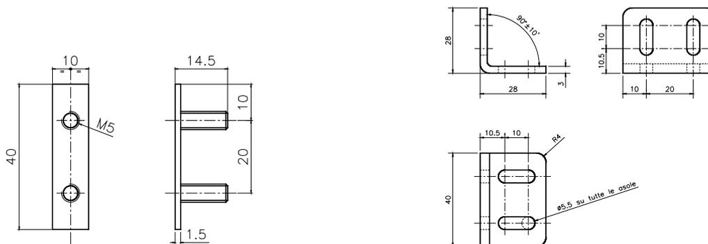
Figura 28 - Encastres FIE y bridas de fijación LE (entregados)
