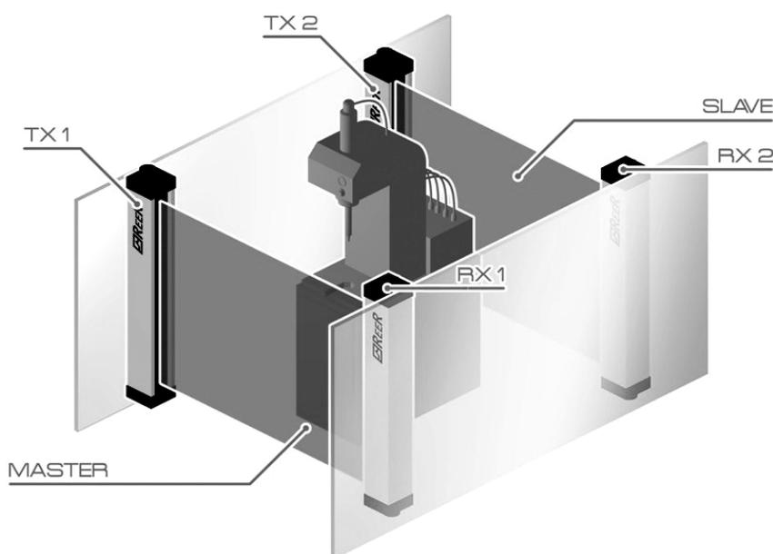
Figura 4 - Ejemplo de aplicación MASTER/SLAVE con protecciones mecánicas
