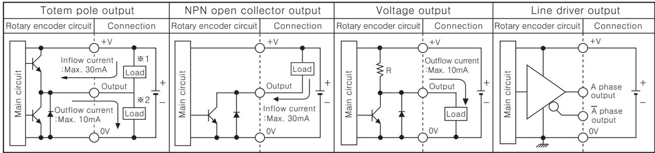
※ Totem pole output type can be used for NPN open collector output type(※1) or Voltage output type(※2).
