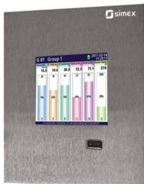
El **CMC-99SL es un MultiCon para montaje en panel**, su característica es la poca profundidad de su carcasa -sólo 50 mm!. Todos los conectores se alojan a los costados del dispositivo, como en una computadora. Como se limitan la cantidad de entradas y salidas, este diseño apunta a sistemas con baja cantidad de señales o sistemas que incluyan otros sistemas de medición con interfases Modbus RTU. Una interfase Ethernet permite actualizar cada MultiCon de manera simple.
